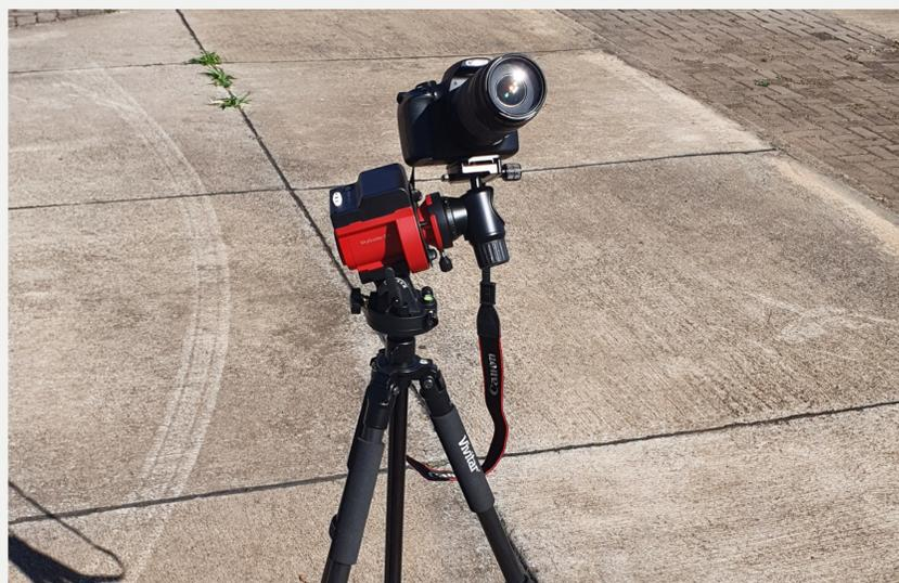
Câmera fotográfica com acompanhamento equatorial acoplado, equipamento para astrofotografia. Fonte: Rodrigo González.
